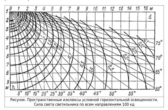
Одновременно по радиальным лучам находится значение  $\alpha$  и по кривой силы света светильника определяется  $I_{\alpha}$ , после чего рассчитывается :
