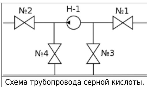
Отключение электропривода насоса серной кислоты от электрической сети производить с учётом представленной схемы подключения электропривода.
