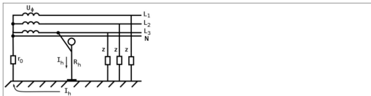
Прикосновение человека к фазному проводу четырёхпроводной сети с заземлённой нейтралью.
