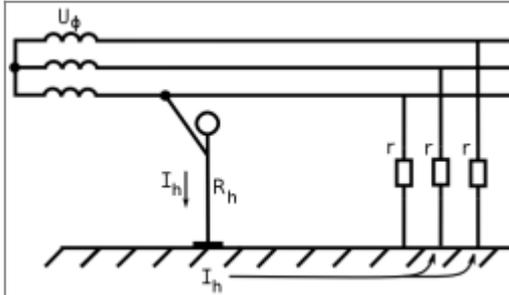
Прикосновение человека к проводу трёхфазной трёхпроводной сети с изолированной нейтралью. Случай нормального режима короткой воздушной сети с малой ёмкостью проводов относительно земли.
