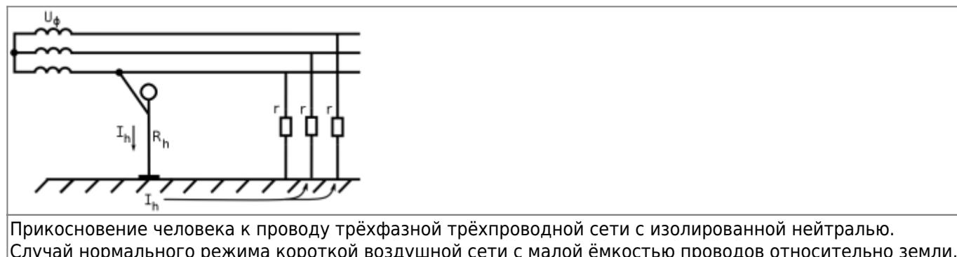
Прикосновение человека к проводу трёхфазной трёхпроводной сети с изолированной нейтралью.
