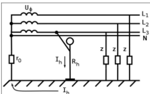
Прикосновение человека к фазному проводу четырёхпроводной сети с заземлённой нейтралью. Нормальный режим работы сети.
