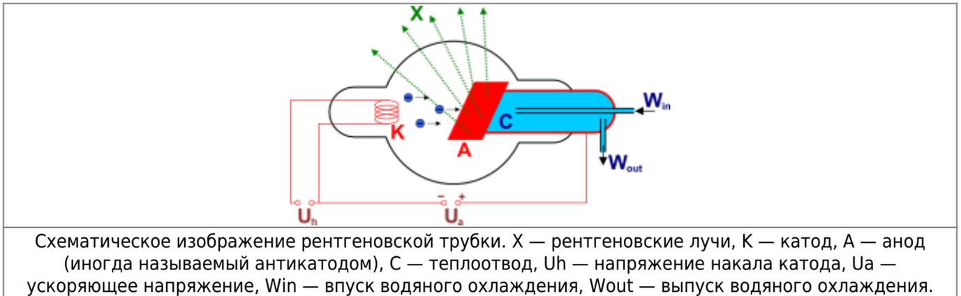
При этом за счёт тормозного излучения происходит генерация излучения рентгеновского диапазона, и одновременно выбиваются электроны из внутренних электронных оболочек атомов анода. Пустые места в оболочках занимают другими электронами атома. При этом также испускается рентгеновское излучение с характерным для материала анода спектром энергий.
