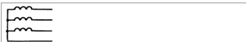
Трёхфазная сеть. Четырёхпроводная с изолированной нейтралью.
