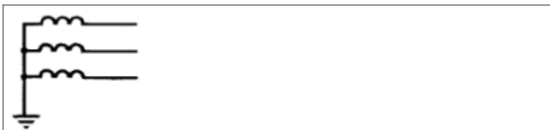
Трёхфазная сеть. Трёхпроводная с заземлённой нейтралью.
