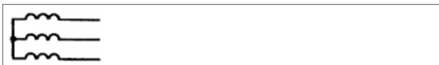
Трёхфазная сеть. Трёхпроводная с изолированной нейтралью
