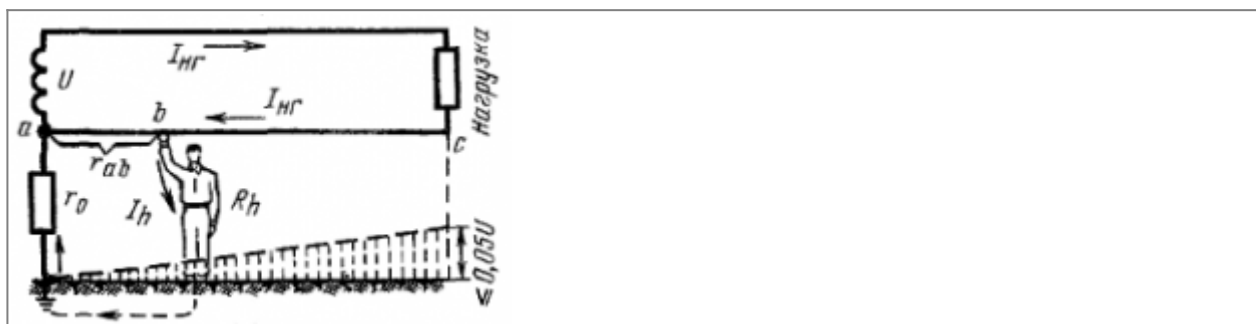
Прикосновение человека к заземлённому проводнику однофазной двухпроводной сети. Нормальный режим работы сети.
