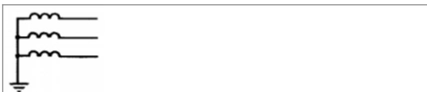
Трёхфазная сеть. Трёхпроводная с заземлённой нейтралью.
