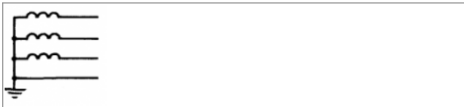
Трёхфазная сеть. Четырёхпроводная с заземлённой нейтралью.
