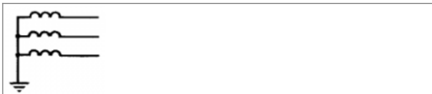
Трёхфазная сеть. Трёхпроводная с заземлённой нейтралью.
