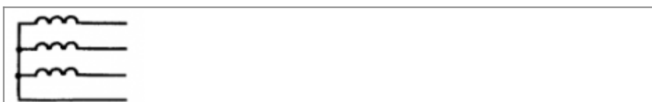
Трёхфазная сеть. Четырёхпроводная с изолированной нейтралью.
