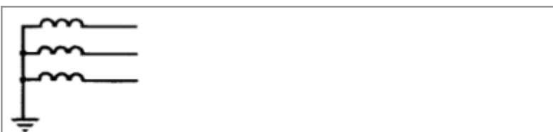
Трёхфазная сеть. Трёхпроводная с заземлённой нейтралью.
