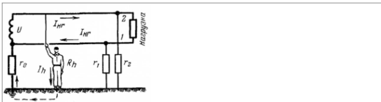
Прикосновение человека к незаземлённому проводнику однофазной двухпроводной сети. Нормальный режим работы сети.
