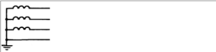
Трёхфазная сеть. Четырёхпроводная с заземлённой нейтралью.
