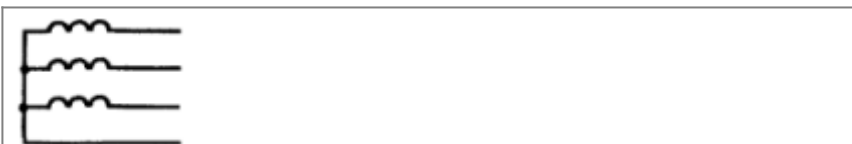
Трёхфазная сеть. Четырёхпроводная с изолированной нейтралью.
