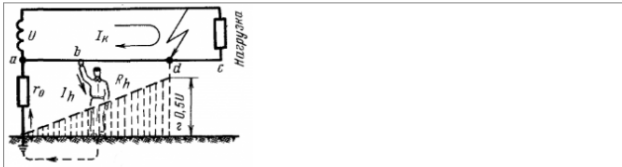
Прикосновение человека к заземлённому проводнику однофазной двухпроводной сети. Аварийный режим работы сети.
