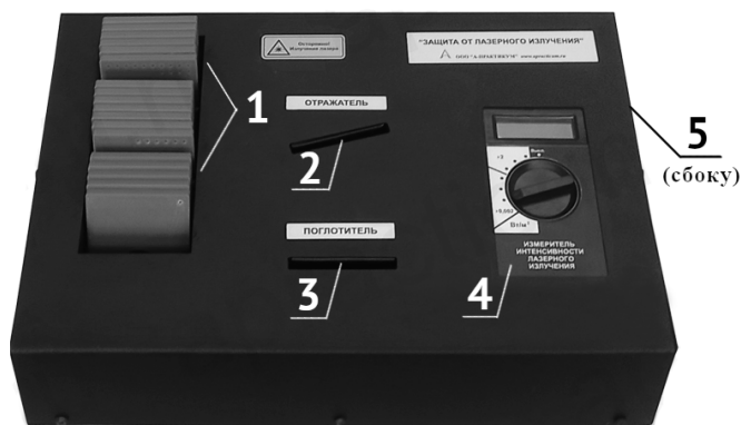
Рис. 6.3. Стенд для исследования методов защиты от лазерного излучения: 1 – отражатели и поглотители; 2 – место установки отражателей; 3 – место установки поглотителей; 4 – органы управления и индикации прибора для измерения интенсивности лазерного излучения; 5 – кнопка питания «Сеть»
