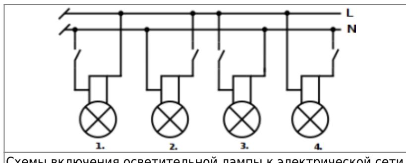
Схемы включения осветительной лампы к электрической сети.
