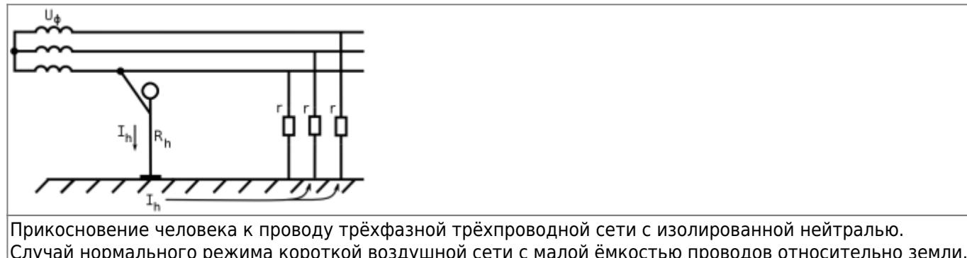
Здесь  $U_\Phi$  - фазное напряжение сети, В;  $R_h$  - сопротивление тела человека, Ом;  $r$  - активное сопротивление изоляции проводов, Ом.
