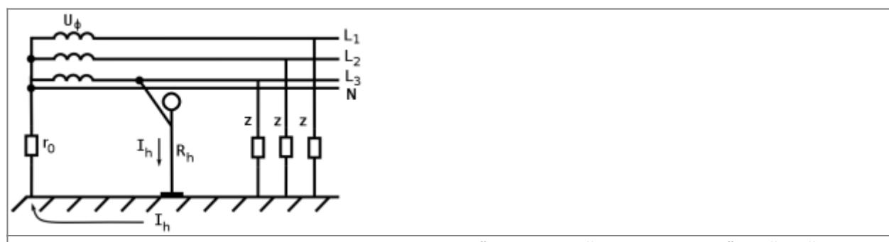
Здесь  $z$  - модуль комплексного сопротивления (полное сопротивление) проводов относительно земли, Ом;  $r_0$  - сопротивление заземления нейтральной точки трансформатора, Ом. Согласно ПУЭ  $r_0$  не должно превышать 4 - 10 Ом.
