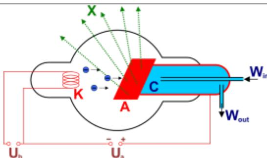
Схематическое изображение рентгеновской трубки. X — рентгеновские лучи, K — катод, A — анод (иногда называемый антикатодом), C — теплоотвод,  $U_h$  — напряжение накала катода,  $U_a$  — ускоряющее напряжение,  $W_{in}$  — впуск водяного охлаждения,  $W_{out}$  — выпуск водяного охлаждения.
